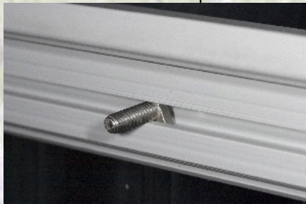
Ansicht nach dem verkanten und vor der Fixierung mittels einer M6-Mutter
